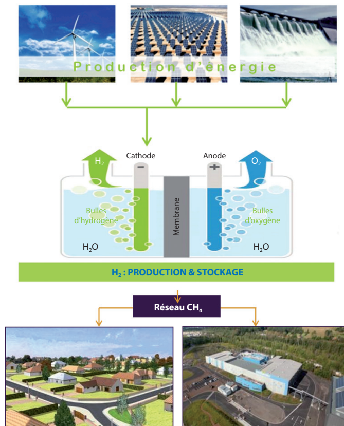
Figure 2 – Valoriser intelligemment les surplus d'énergie électrique par le « Power to Gas ». Cette technique consiste à produire de l'hydrogène par électrolyse de l'eau grâce au surplus d'électricité générée par les énergies renouvelables, et de l'injecter dans le réseau de gaz naturel. Source : courtoisie AFHYPAC, Mcphy.
