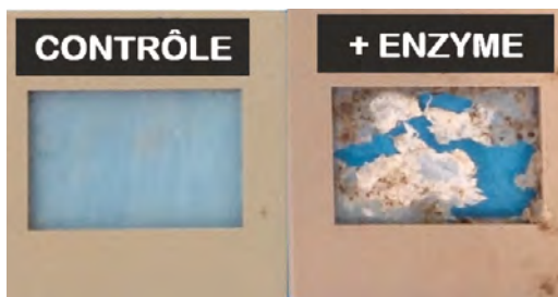
Figure 5 – À gauche, un échantillon de PLA « standard », à droite un PLA enzymé, après 7 jours en sol. Le PLA enzymé est presque totalement dégradé, alors que l'autre est intact.
