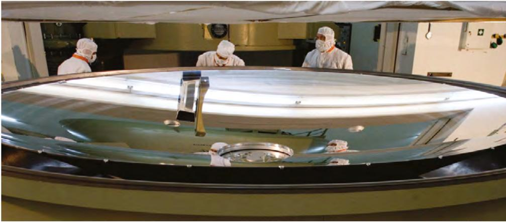
Figure 4 – Le miroir principal d'Herschel est recouvert d'une couche de métal d'environ 1 mm d'épaisseur et on polit la surface avec une précision de 3 microns, nécessaire pour assurer les performances des instruments embarqués. Source : ESA.
