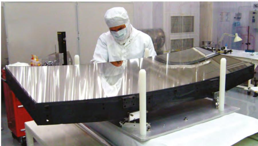
Figure 6 – Les grands miroirs de Gaïa doivent avoir une précision de finition de surface de 10 nm pour une observation dans le domaine visible, ce qui est encore plus exigeant que pour Herschel qui travaille avec des longueurs d'onde submillimétriques. Source : ESA / Airbus.
