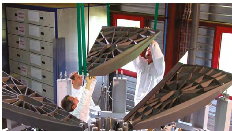
Figure 10 – Le télescope Herschel est constitué de douze pétales qui sont fabriqués en carbure de silicium.
