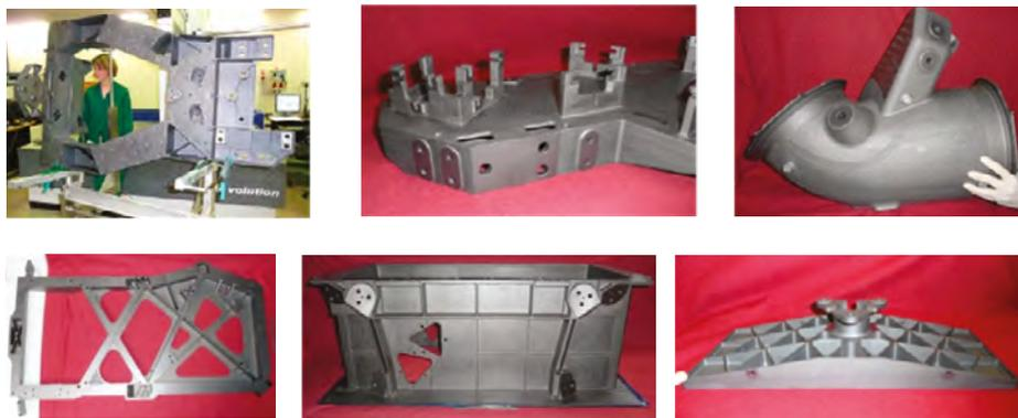
Figure 12 – Série de pièces en carbure de silicium utilisées pour Gaïa, instrument construit comme un immense lego. Source : Airbus Defence & Space.
