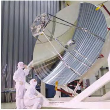
Figure 1 – Le télescope Herschel finalisé, avec son miroir primaire de 3,5 mètres de diamètre.
