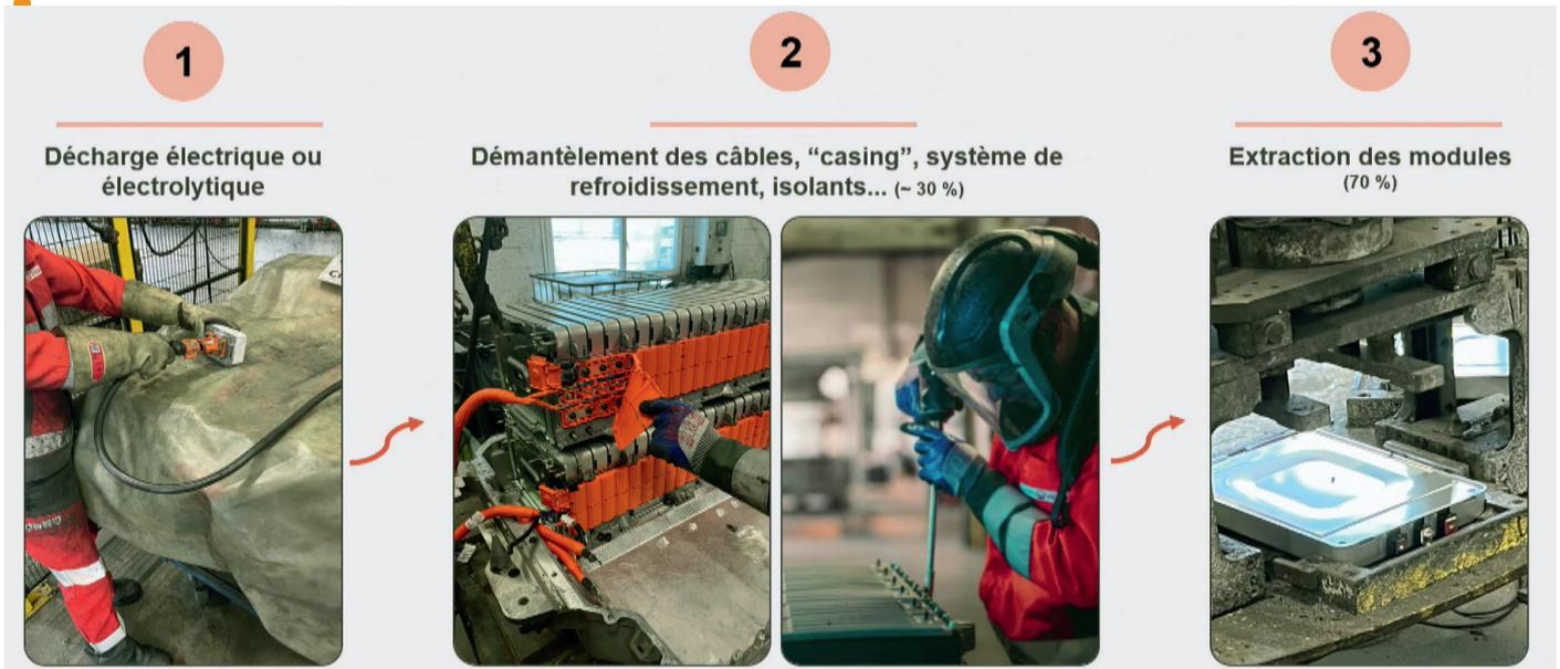
Il faut tout d'abord décharger toutes les batteries avant de commencer à les démonter pour retirer les modules contenant des cellules, élément de base d'une batterie électrique.
