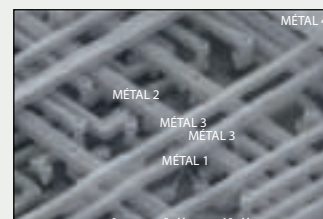
Vues latérale et de dessus d'un transistor au microscope électronique à balayage (MEB)
