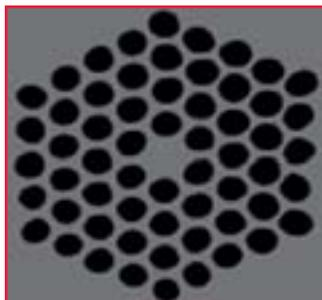
l'infrarouge (Figure 24). On a réalisé des lasers infrarouges avec ces fibres mille fois plus brillants que le soleil ! Ce type de laser pourrait servir à détecter des espèces chimiques polluantes dans l'atmosphère, car ces espèces ont une absorption forte dans l'infrarouge.
