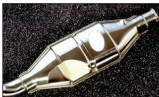
c'est Peugeot qui a installé en 2000 les premiers filtres à particules sur son modèle de 608. Les filtres à particules ont ensuite été systématiquement installés sur toutes les voitures diesel commercialisées à partir de 2009. Ils sont capables de piéger plus de 99,9 % des particules de suies (**Figure 5**).
