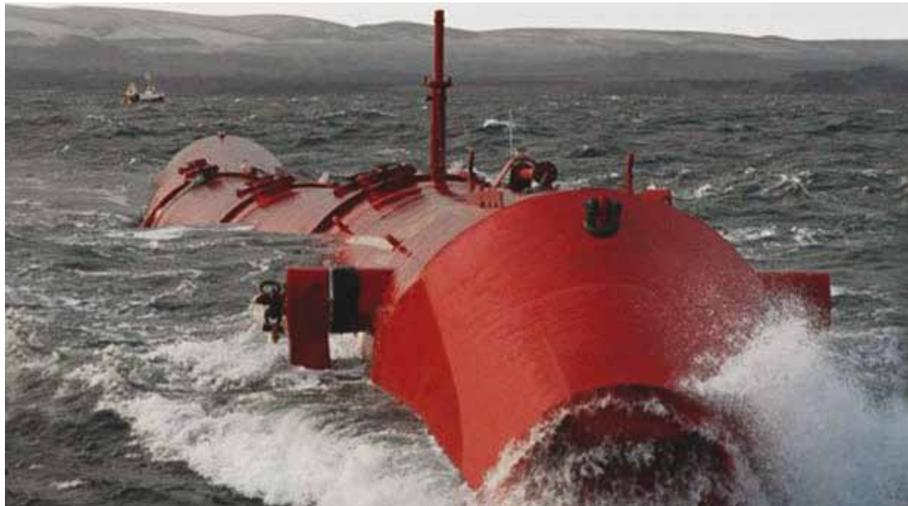
Figure 3 : Dispositif de récupération de l'énergie des vagues, puissance 750 KW (Source Pelamis, 2007).
