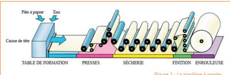
Figure 1 - La machine à papier.
