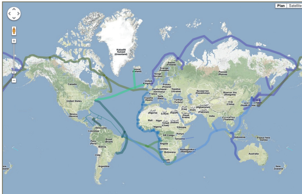
Figure 6 : Répartition des nouveaux câbles à fibre optique sur la planète.
