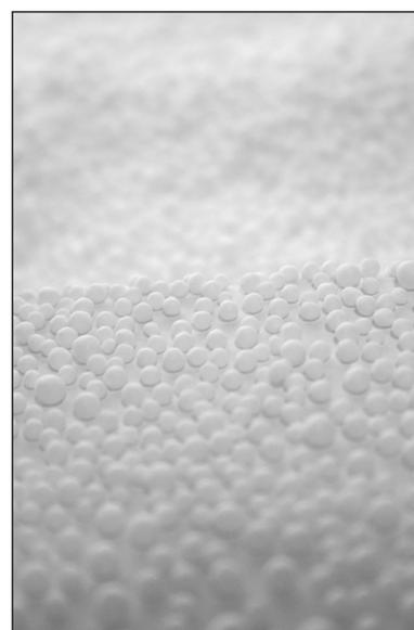
4. Polystyrène expansé : c'est la forme la plus courante du polystyrène, il se présente sous forme de petites billes blanches et est utilisé pour protéger des chocs ou comme isolant thermique ou phonique.
