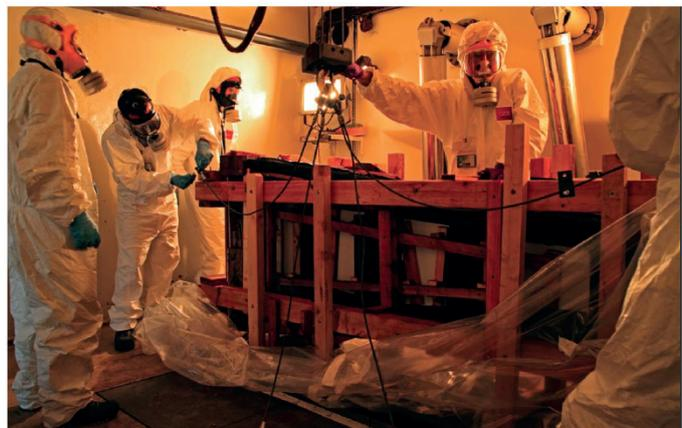
Figure 8 – Positionnement de la proue du bateau imprégnée de résine styrène-polyester dans la cellule d'irradiation.
