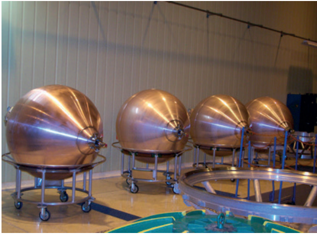
Figure 6 – Réservoirs sphériques développés par la société Air Liquide, susceptibles de stocker l'hydrogène liquide des futurs avions.
