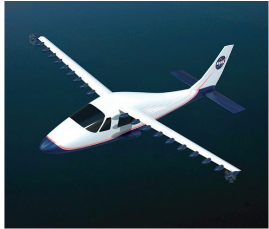
Figure 4 – Spector, le laboratoire volant de la NASA pour l'étude de la propulsion distribuée qui vise à diviser par 5 la consommation de carburant. Source : NASA
