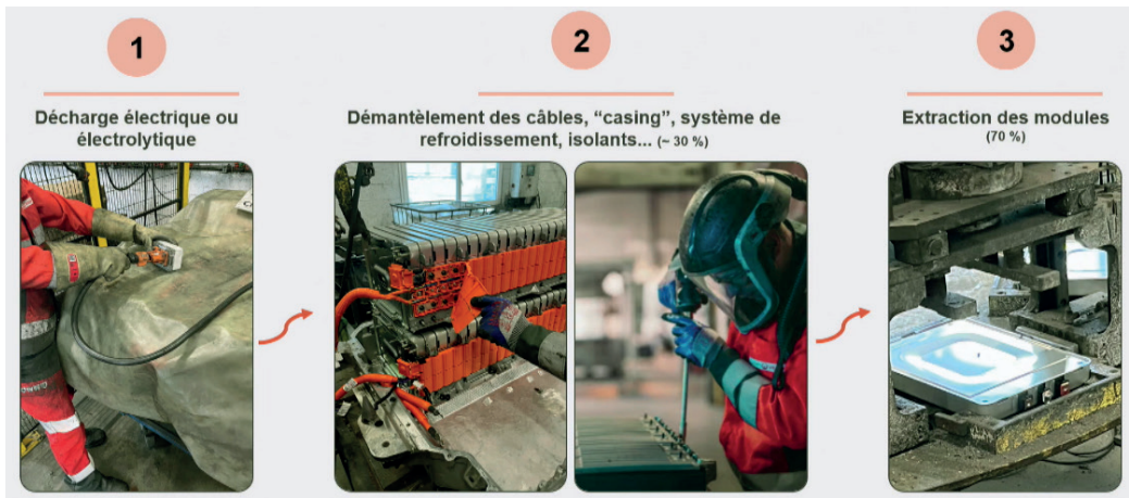
Figure 8. Premières étapes du recyclage : sécuriser et démonter la batterie. Source : « Chimie, Recyclage et Économie circulaire », 2024, p. 120.
