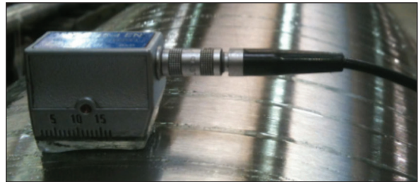
Figure 9. Méthode de contrôle par ultrasons. Source : https://ndt-inspections.fr/contrôles-volumiques .
