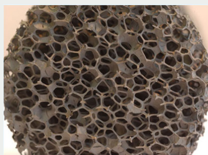
Figure 2 : Mousse en nid d'abeille utilisée au niveau du pot d'échappement d'une automobile.
