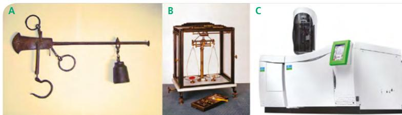
Figure 6 A) Balance romaine ; B) balance de Sartorius ; C) instrument CG/MS (chromatographie en phase gazeuse couplée à la spectrométrie de masse) (Perkin Elmer, modèle SQ8).
