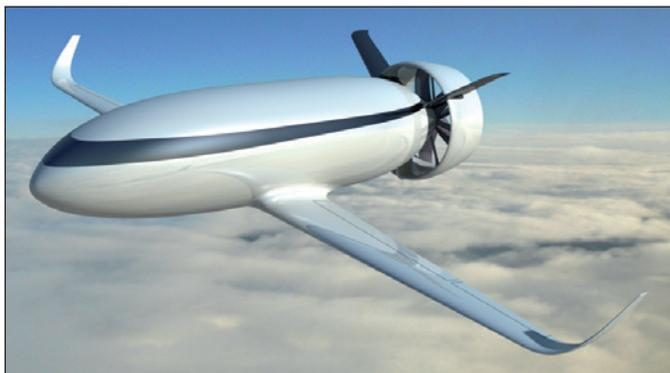
dans son aérodynamisme. On remarquera sur la **Figure 2** qu'il n'y a plus de moteur sous les ailes pour avoir un flux extrêmement laminaire.
